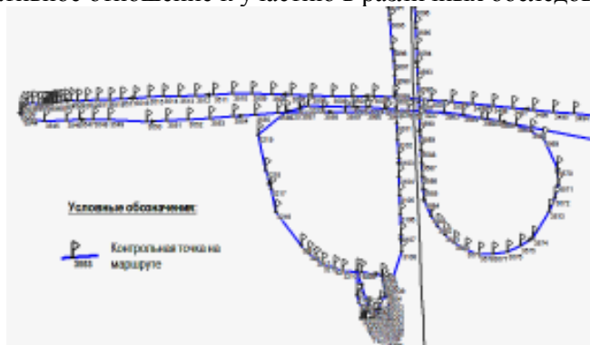
Рис. 1. Пример анализа характеристик маршрута следования с использованием gps-трекера в г. Иркутске (левобережный подход к Новому мосту через р. Ангара). Контрольные точки выставляются на маршруте через заданный интервал времени
